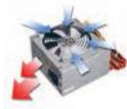
شکل ۲۳- جهت تهویه هوا در منبع تغذیه
