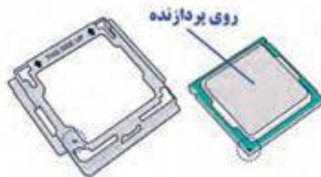
شکل ۳۴- نشانه روی پردازنده و سوکت
