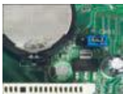
شکل ۱۴- جامپر Clear CMOS
