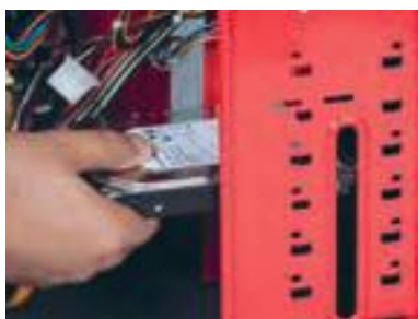
شکل ۴۸- محل نصب دیسک سخت
